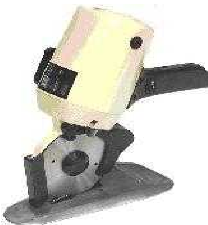
ER531C000024 Taglierina KM SV SC1007 Diametro lama 50 mm.(tonda,6 lati, 8 lati) Capacità di taglio 6 mm 220v 45W Peso Kg. 1,1
